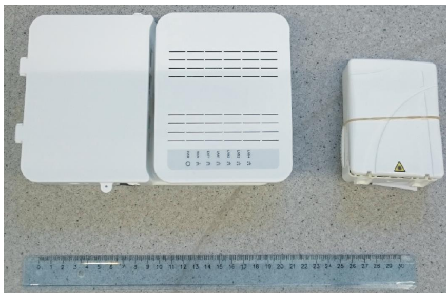
Bredbandsuttaget är den mindre dosan till höger och BBS är dosan till vänster.
